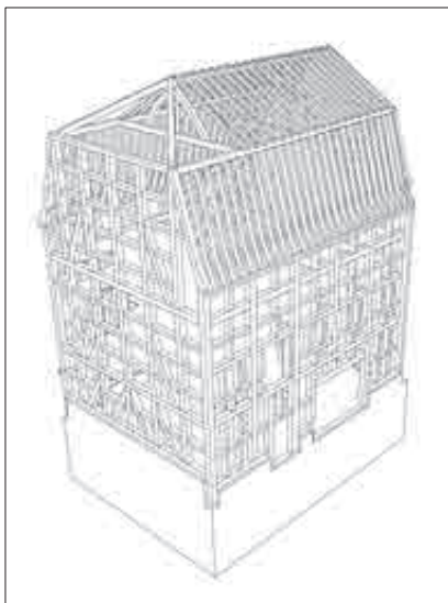
Fig. 24.- Idem, modélisation en 3D de la structure.
