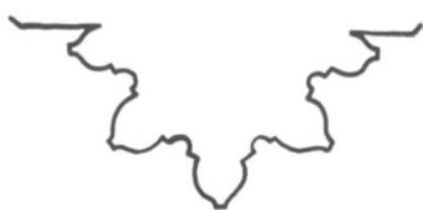
FIG. 52. Profil des pilastres des bas-côtés. Relevé de l'auteur.
