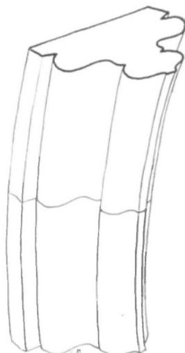
FIG. 21. Profil d'une nervure de la voûte du rez-de-chaussée de la tour.
