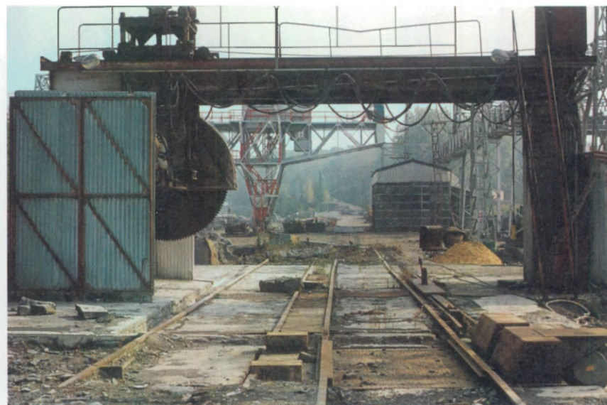
4. Scie circulaire sur les chantiers actuels de la carrière Gauthier-Wincqz. Photographie G. BAVAY.
