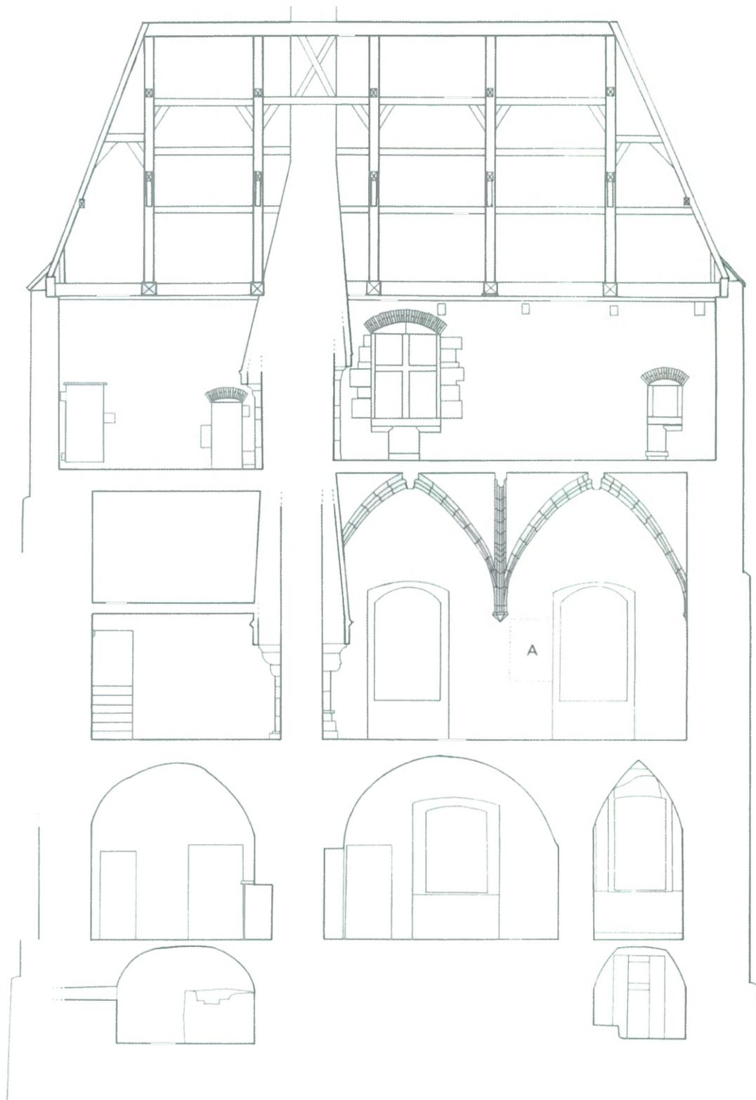
Fig. 18. - Château de Fosteau, la maison forte, coupe du corps quadrangulaire, vue vers le nord, état en 2002. Relevé de l'auteur. La lettre A situe la fenêtre murée au linteau en bâtière.
