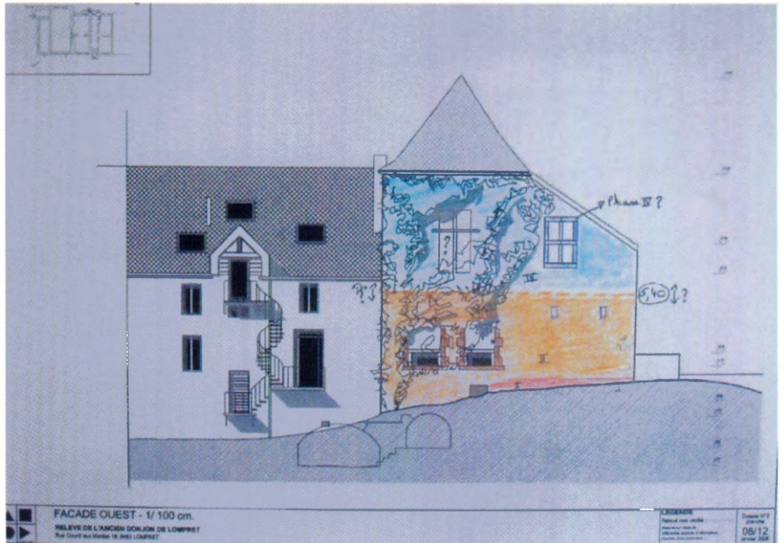
Fig. 14. - Relevé de la façade ouest des structures A et B. Architecte Jean de Salle, Dossier d'étude préliminaire à la restauration du donjon de Lompret, fascicule de plans n°3, Cooparch - R.U. srl avec le soutien de la Fondation Wartoise, 2006.
