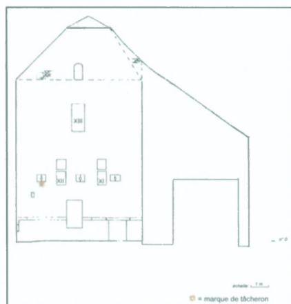
Fig. 9. - Structure A, façade sud : schéma d'élévation avec distribution des marques de tâcheron. Dessin de l'auteur.
