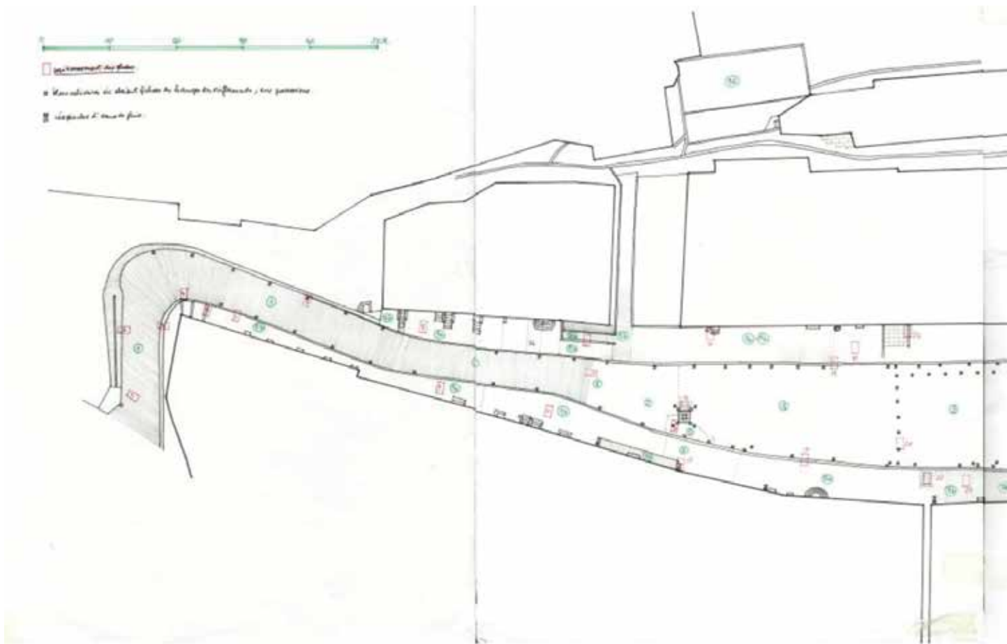
Fig. 27.- Relevé de la Place Saint-Georges à Limbourg, 1992. La cartographie très précise de toutes les zones aux revêtements différents est accompagnée d'une description détaillée des constituants et de leurs mises en œuvre, et de photographies de détails, à la même échelle, ainsi que de clichés plus généraux. L'ensemble constitue un état des lieux d'une exceptionnelle précision. © S.P.W., D.G.O.4, Marie-Ange Remy-Closos et Gérard Michel.
