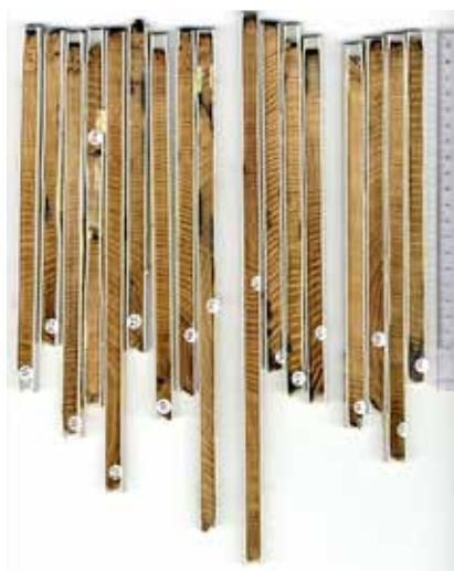
Fig. 6.- Scan des échantillons dendrochronologiques des ailes ouest et nord. © Patrick Hoffsummer (ULg-CEA 2012).
