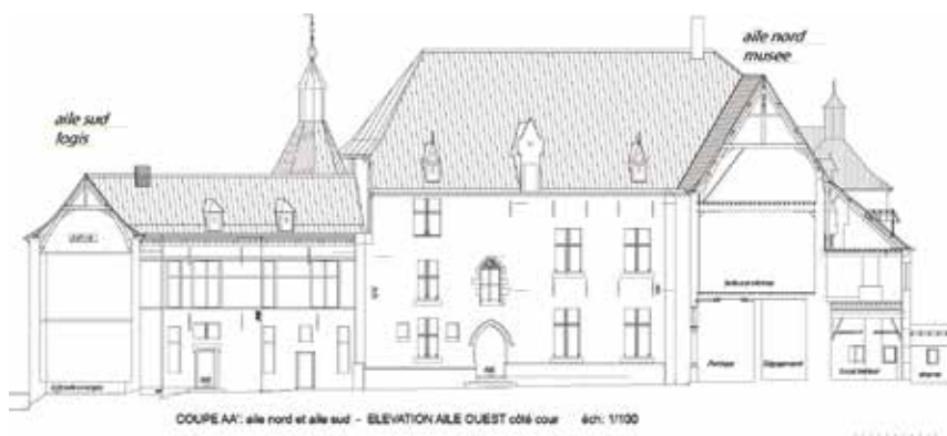
Fig. 5.- Élévation de l'aile ouest côté cour et coupe dans l'aile nord et dans l'aile sud.
