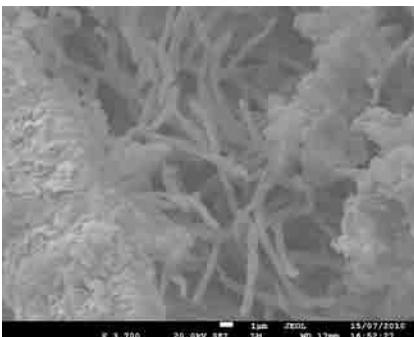
Fig. 26.- Image MEB des micro-organismes envahissant la porosité des mortiers jaunes.
